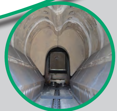
Cámara de combustión con cadenas para eliminación de cenizas
